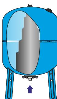
Si prosegue con l'erogazione di acqua all'impianto, la membrana si sgonfia, sino al raggiungimento della pressione di soglia minima dell'impianto. A questo punto, la membrana è ritornata alle dimensioni iniziali, la pompa si riavvia ed il ciclo si ripete. Poiché la gamma "acqua fredda" garantiscono in ogni istante la massima quantità di acqua possibile, le partenze della pompa sono ridotte al minimo.
