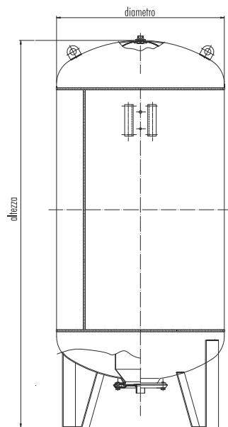
**Utilizzo:** Vaso autoclave con membrana intercambiabile per circuiti di acqua sanitaria.
