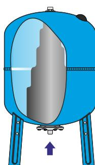
Tutti i vasi "acqua fredda" escono dalla fabbrica controllati, verificati e certificati. La membrana intercambiabile evita qualunque contatto tra aria ed acqua impedendo ogni possibile perdita di pressione, contaminazione e corrosione. Una volta connesso al circuito a cui è destinato, la pompa parte facendo aumentare la pressione dell'impianto, facendo entrare l'acqua nella membrana.
