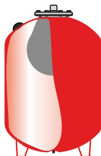
Tutti i vasi della serie VR (VRV, VS e VSV) escono dalla fabbrica controllati, verificati e certificati. Una volta connesso al circuito a cui è destinato, all'aumentare della temperatura, aumenta il volume dell'acqua che espandendosi comincia a riempire la membrana.
