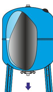
Quando la pressione dell'impianto raggiunge il valore di soglia massima impostata la pompa si arresta. Nel vaso vi è la quantità massima d'acqua accumulabile. Naturalmente la membrana si è dilatata ed occupa la quasi totalità del volume interno del vaso. Se richiamata dall'impianto l'acqua comincia ad uscire senza l'aiuto della pompa sfruttando la pressione dell'aria della camera pressurizzata.
